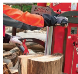
Linke Bedienungshebel mit integrierter Spaltgutfixierung
